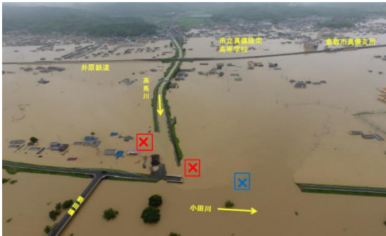
撮影日時：平成30年7月7日14時-17時頃 河川の堤防決壊・損傷により、1,200haにわたり浸水被害が発生
